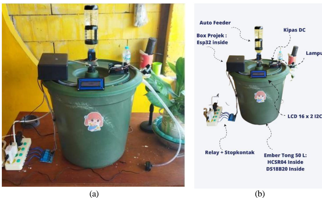
Gambar 2. (a) Prototipe; (b) Spesifikasi Alat Prototipe
